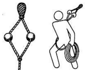
**Спасательный багор** служит для извлечения пострадавшего из воды. Он состоит из шеста длиной 4-5 м., на конце которого укреплен железный оцинкованный крюк с нанизанными пробками или пенопластовыми шарами различного диаметра.
